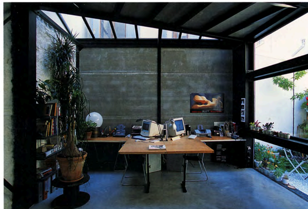
Le jardin depuis l'atelier. Au rez-de-jardin comme aux étages supérieurs, sol en béton ciré contenant des fibres de verre qui évitent la formation de fissures.
